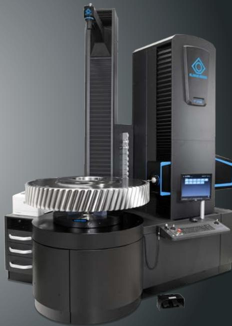
Präzisionsmesszentrum P 152 – Bauteile bis zu einem Außendurchmesser von 1.520 mm sowie einem Werkstückgewicht von maximal 8.000 kg werden mit der gewohnten Präzision gemessen.
