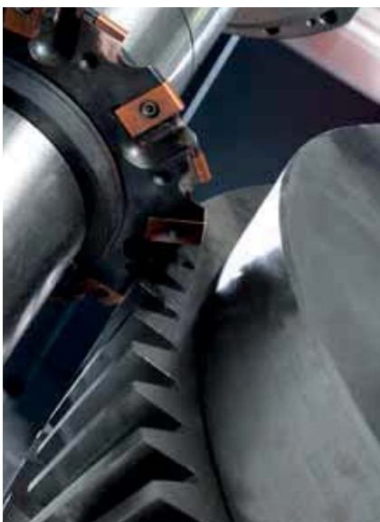
Abb. 4: Höchster Produktivitätsvorteil durch Vorbearbeitung mit Formfräsworkzeugen
