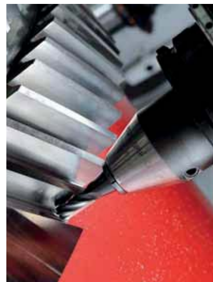
Abb. 6: Fingerfräsen – Schichten der Flanke
